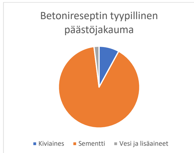
Kuva 3. Tyypillisen betonireseptin päästöjakauma
